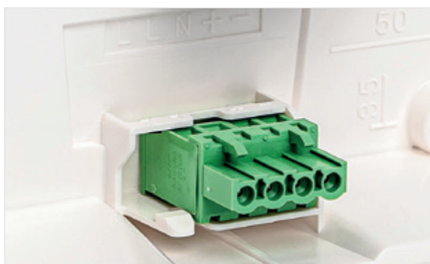
Bornas de conexión de tornillo y extraíbles, que permiten coger la borna con la mano, conectar los cables, y fijarlas en su posición de conexión en la base. Con capacidad para 1 x 2,5 mm 2 .
